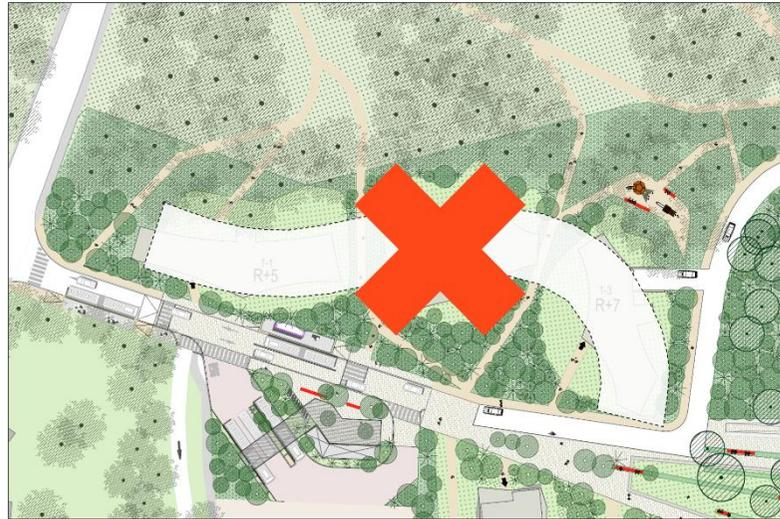
**Repositionnement des 90 places de stationnements sur un 2ème niveau de sous-sol sous l'émergence :**
