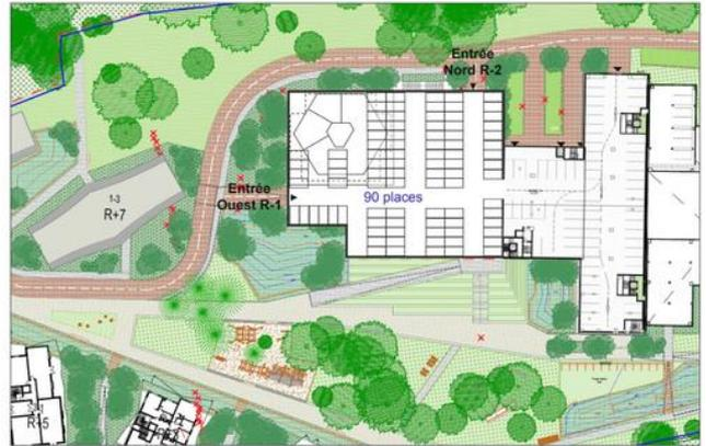
SUPPRESSION DU PARKING DE L'ÎLOT LISIÈRE ET REPOSITIONNEMENT DES 90 PLACES DE STATIONNEMENTS SUR UN 2<sup>ÈME</sup> NIVEAU DE SOUS-SOL SOUS L'ÉMERGENCE
