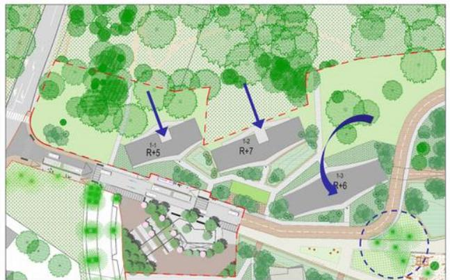
REPOSITIONNEMENT DE L'IMPLANTATION DES 3 BÂTIMENTS PERMETTANT DE LES ÉLOIGNER D'AVANTAGE DE LA LISIÈRE DU BOIS DE PORCÉ
